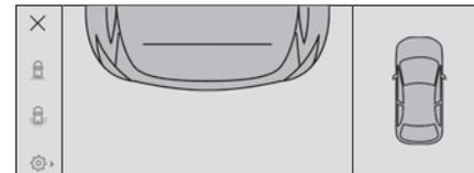
Die hintere Kamera zeichnet bei den Fahrmanövern die Umgebung auf, um eine Draufsicht vom Heck des Fahrzeugs in seiner unmittelbaren Umgebung erstellen zu können, sodass mit dem Fahrzeug Fahrmanöver im Verhältnis zu den umgebenden Hindernissen vorgenommen werden können. Mithilfe der Sensoren an der hinteren Stoßstange wird die automatische Zoom-Ansicht angezeigt, wenn Sie sich während des Manövers einem Hindernis an der roten Linie (weniger als 30 cm) nähern.
