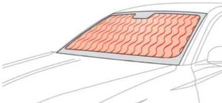
Bei Kälte beheizt diese Funktion die gesamte Windschutzscheibe und ergänzt das Automatikprogramm „Sicht“, indem Sichtbeeinträchtigungen (z. B. Tau, Nebel, Frost, Schnee) an beiden Seiten der Windschutzscheibe schneller entfernt werden.
