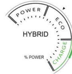
**POWER** **Hohe Leistungsanforderung, wobei die kombinierte Energie des Benzinmotors und des Elektromotors genutzt wird.**
