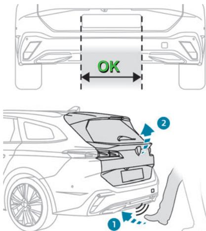
► Stellen Sie sich hinter das Fahrzeug am Kennzeichen und führen Sie eine Fußbewegung im Erkennungsbereich „OK“ aus.
