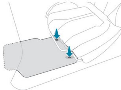
Benutzen Sie, wenn Sie die Fußmatte auf der Fahrerseite anbringen, nur die im Bodenbelag vorhandenen Befestigungen (ein „Klick“ bestätigt die korrekte Befestigung).
