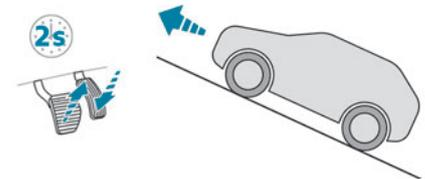
**Bergauf wird das stehende Fahrzeug kurzzeitig angehalten, wenn das Bremspedal gelöst wird:**
