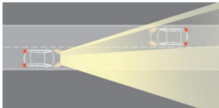
Wenn sich ein entgegenkommendes Fahrzeug nähert, werden nur die Leuchtensegmente ausgeschaltet, die auf dieses Fahrzeug gerichtet sind, wodurch während der Annäherung ein „Tunnel“ erzeugt wird.
