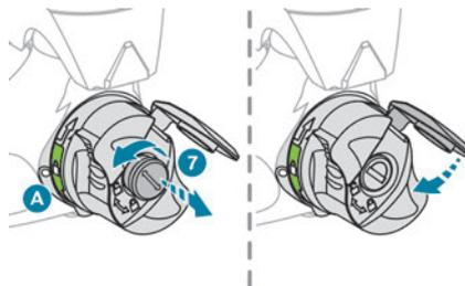
► Achten Sie darauf, dass der Mechanismus richtig einrastet und die grüne Markierung auf dem Rad mit der weißen Markierung auf dem Kugelkopf übereinstimmt (Position A).
