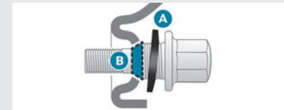
Wenn Ihr Fahrzeug mit Leichtmetallfelgen ausgerüstet ist, haben die Unterlegscheiben **A** keinen Kontakt mit dem Stahlreserve- oder Notrad. Der sichere Halt des Notrads wird durch die konische Fläche **B** der einzelnen Schrauben gewährleistet.
