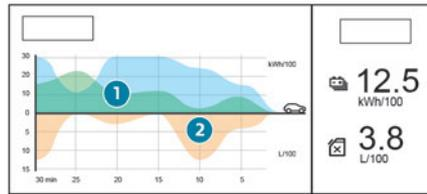
1. Durchschnittlicher Energieverbrauch der aktuellen Fahrt (kWh/100 km) sowie frühere Werte:
