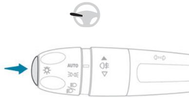
► Drücken Sie auf die Taste am Ende des Lichtschalterhebels, um durch die verschiedenen Seiten zu scrollen.
