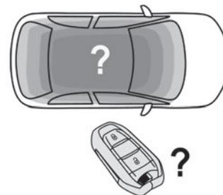
Wenn der elektronische Schlüssel nicht erkannt wird oder sich nicht mehr im Erkennungsbereich befindet, erscheint beim Schließen einer Tür oder bei dem
