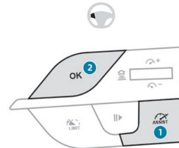
► Nachdem Sie die Umgebung des Fahrzeugs kontrolliert haben, drücken Sie auf **2-OK**, um den Beginn des Manövers zum Spurwechsel zu bestätigen.
