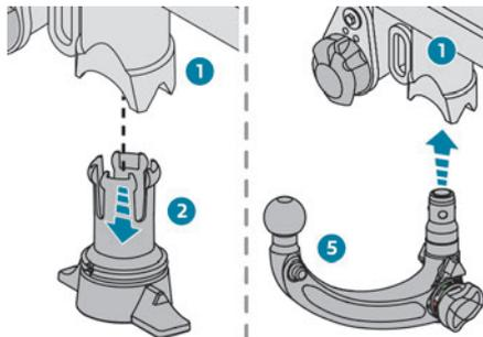
► Entfernen Sie die Schutzkappe 2 der Halterung 1 unter der hinteren Stoßstange.
