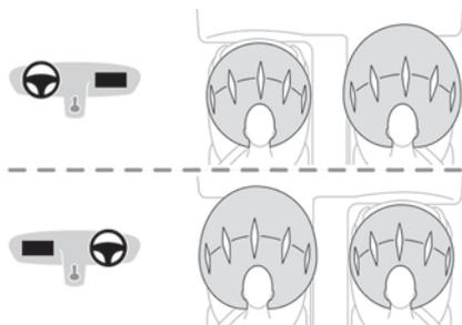
Dieses System schützt bei einem starken Frontalaufprall Fahrer und Beifahrer und vermindert die Verletzungsgefahr im Kopf- und Brustbereich. Auf der Fahrerseite ist der Airbag in der Mitte des Lenkrads eingebaut, auf der Beifahrerseite im Armaturenbrett oberhalb des Handschuhfachs.
