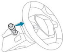
► Ziehen Sie den Lichtschalterhebel bei ausgeschalteter Zündung zu sich heran („Lichthupe“), um die Funktion zu aktivieren/deaktivieren.
