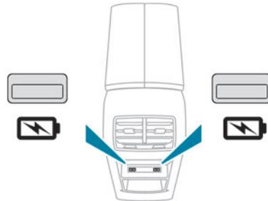
Jeder USB-Anschluss dient ausschließlich der Stromversorgung oder dem Aufladen jeweils eines tragbaren Geräts.
