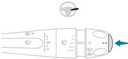
► Durch Drücken der Taste am Ende des Scheibenwischerhebels werden nacheinander die verschiedenen Registerkarten angezeigt:
