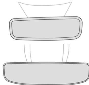
Das elektrochrome System verwendet einen Sensor, um den Grad der Außenhelligkeit sowie den Helligkeitsgrad hinter dem Fahrzeug zu erfassen, um automatisch und schrittweise zwischen Tag- und Nachtmodus umzuschalten.
