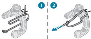
Die Anhängerkupplung wird mit einem Gurt an der Kofferraumöse befestigt.
