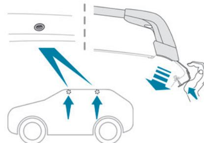
Die Querträger dürfen ausschließlich an den vier Verankerungspunkten auf dem Dachrahmen angebracht werden. Bei geschlossenen Türen werden diese Befestigungspunkte durch die Türen verdeckt. Das Befestigungsmaterial der Dachträger beinhaltet einen Stift, der in die Öffnung der jeweiligen Verankerungspunkte eingeführt werden muss.
