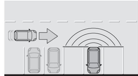
Beim Einlegen des Rückwärtsgangs bei laufendem Motor oder beim Rückwärtsfahren mit bis zu 10 km/h warnt dieses System den Fahrer bei Annäherung an ein Hindernis (z. B. Fußgänger, Radfahrer, Fahrzeug, LKW, Motorrad) in den hinteren toten Winkeln des Fahrzeugs mithilfe der in der Stoßstange installierten Radare. Das System erkennt Hindernisse, die sich in einer maximalen Entfernung von 40 m mit einer Geschwindigkeit von mehr als 3 km/h bewegen.
