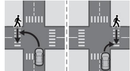
Das System funktioniert, wenn das Fahrzeug links oder rechts abbiegt, und es erkennt einen Fußgänger, der die Kreuzung überquert, wenn:
