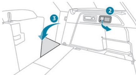
► Ziehen Sie den Hebel zur Entriegelung der Rückenlehne 2 zu sich heran. Die Rückenlehne 3 wird vollständig auf die Sitzfläche umgeklappt.
