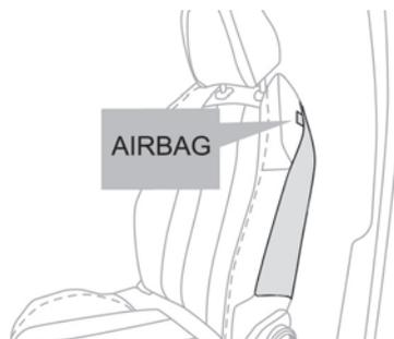
Dieses System schützt bei einem starken Seitenaufprall Fahrer und Beifahrer und vermindert die Verletzungsgefahr im Brustbereich sowie zwischen Hüfte und Schulter.
