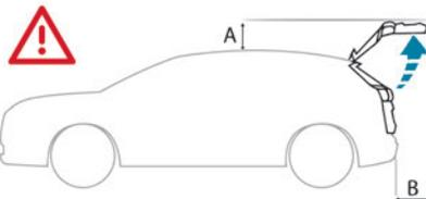
! Achten Sie darauf, dass für das Ausfahren der motorisierten Heckklappe genügend Platz zur Verfügung steht.
