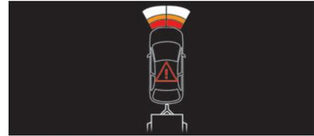
**i** Die Einparkhilfe hinten wird bei Montage eines Anhängers oder eines Fahrradträgers auf der Anhängerkupplung (bei Fahrzeugen mit nach Herstellervorgaben montierter Anhängerkupplung) automatisch deaktiviert. In diesem Fall wird der Umriss eines Anhängers hinter dem Bild des Fahrzeugs angezeigt.
