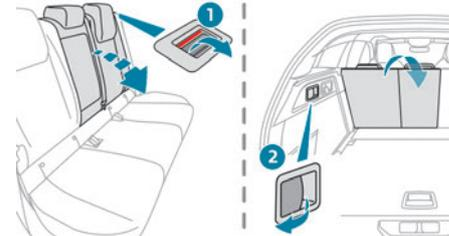
Jedes Rückenlehnelement hat einen oder zwei Hebel zum Entriegeln:
