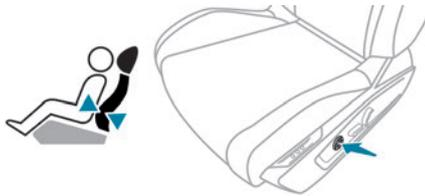
Mit dem Hebel können unabhängig voneinander Tiefe und Höhe der Lendenwirbelstütze im Bereich der Lendenwirbelsäule eingestellt werden.
