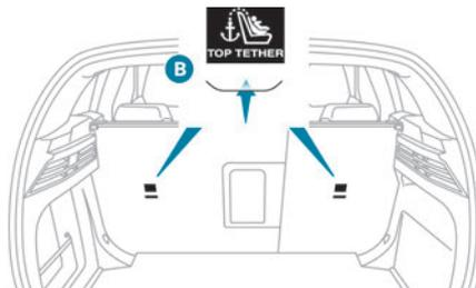
Durch dieses System wird, im Fall eines Frontalaufpralls, eine Kippbewegung des Kindersitzes nach vorne begrenzt. Mit dem ISOFIX-System lässt sich der Kindersitz sicher, stabil und schnell im Fahrzeug montieren. Gehen Sie wie folgt vor, um den Kindersitz am **TOP TETHER** zu befestigen:
