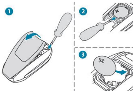
► Öffnen Sie den Deckel, indem Sie einen kleinen Schraubendreher in den Schlitz einführen und den Deckel anheben.
