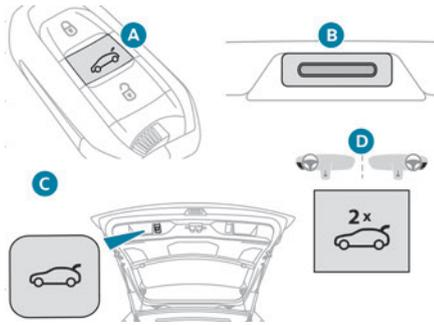
Sie haben mehrere Möglichkeiten, die motorisierte Heckklappe zu betätigen:
