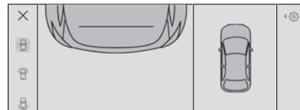
Die vordere oder hintere Kamera zeichnet bei den Fahrmanövern die Umgebung auf, um eine Vorder- oder Rückansicht des Fahrzeugs von oben in seiner unmittelbaren Umgebung erstellen zu können, sodass mit dem Fahrzeug Fahrmanöver im Verhältnis zu den umgebenden Hindernissen vorgenommen werden können.
