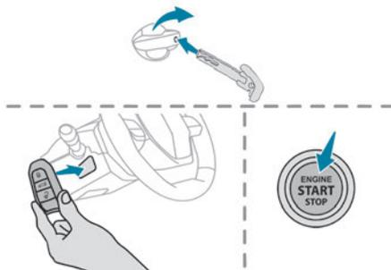
► Stecken Sie den (in der Fernbedienung integrierten) mechanischen Schlüssel in das Schloss, um das Fahrzeug zu öffnen.
