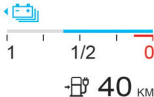
Der Ladezustand der Antriebsbatterie und die verbleibende Reichweite im elektrischen Fahrmodus werden dauerhaft angezeigt, wenn das Fahrzeug eingeschaltet ist.
