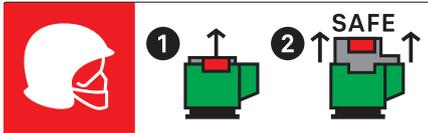
! Dieser Aufkleber ist ausschließlich zur Verwendung durch die Feuerwehr und Wartungsdienste im Falle von Arbeiten am Fahrzeug gedacht. Keine andere Person darf das auf dem Aufkleber abgebildete Gerät berühren.
