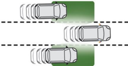
Dieses System warnt den Fahrer mithilfe der in der hinteren Stoßstange installierten Radare, wenn sich Fahrzeuge schnell von hinten auf angrenzenden Fahrspuren nähern (bis etwa 75 m) und wenn sich ein herannahendes Fahrzeug im toten Winkel seines Fahrzeugs befindet.
