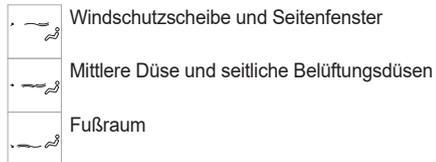
Ein Symbol wird aktiviert, um Luftstöße in der angegebenen Richtung anzuzeigen. Für eine gleichmäßige Verteilung im Fahrzeuginnenraum können die drei Tasten gleichzeitig aktiviert werden.
