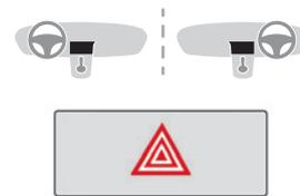
► Durch Drücken dieses Schalters werden die Fahrtrichtungsanzeiger eingeschaltet. Sie funktionieren auch bei ausgeschalteter Zündung.
