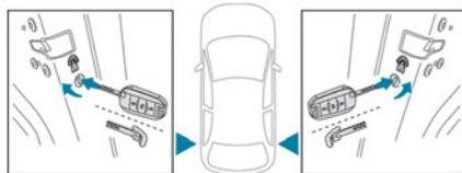
► Zur Aktivierung drehen Sie den integrierten Schlüssel bis zum Anschlag:
