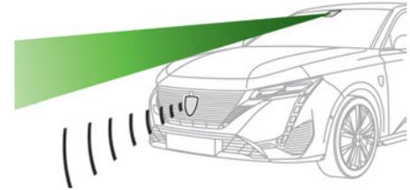
Das Fahrzeug verfügt über eine Multifunktionskamera oben an der Windschutzscheibe und, je nach Ausführung, ein Radar in der vorderen Stoßstange.
