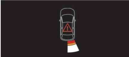
Diese ergänzt, unabhängig von der Fahrtrichtung des Fahrzeugs, das akustische Signal durch Anzeige von Balken auf dem Bildschirm, die den Abstand zwischen dem Hindernis und dem Fahrzeug darstellen (weiß: in größerer Entfernung, orange: in der Nähe, rot: in unmittelbarer Nähe). In unmittelbarer Nähe des Hindernisses erscheint das Symbol „Gefahr“ auf dem Bildschirm.
