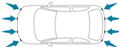
Mithilfe der Sensoren im Stoßfänger erkennt und signalisiert dieses System die Nähe zu einem Hindernis (z. B. Fußgänger, Fahrzeug, Baum, Schranke).
