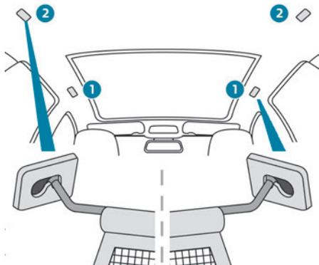
Dieses abnehmbare Rückhaltenetz wird an den speziellen oberen und unteren Befestigungen eingehängt und ermöglicht die Nutzung des gesamten Ladevolumens bis zum Dach:
