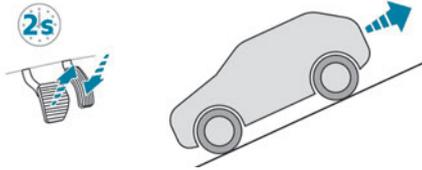
**Bergab wird das stehende Fahrzeug bei eingelegtem Rückwärtsgang kurzzeitig angehalten, wenn das Bremspedal gelöst wird.**
