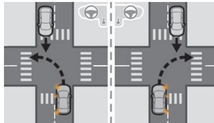
Das System funktioniert, wenn das Fahrzeug abbiegt und erkennt ein sich aus entgegengesetzter
