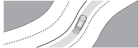
Das System erkennt die Grenzen der Fahrspur und lenkt das Fahrzeug, sodass es in der Fahrspur bleibt und um es in der durch den Fahrer ausgewählten Position zu halten.
