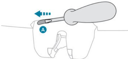
► Führen Sie einen kleinen Schraubendreher in die Öffnung **A** des Schlosses ein, um den Kofferraum zu entriegeln.
