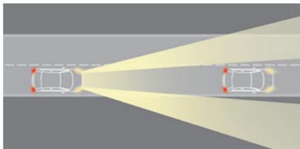
Wenn Sie sich einem Fahrzeug von hinten nähern, werden nur die Leuchtensegmente ausgeschaltet, die auf das vorausfahrende Fahrzeug gerichtet sind, wodurch ein „Tunnel“ erzeugt wird, um den Fahrer des vorausfahrenden Fahrzeugs nicht zu blenden.
