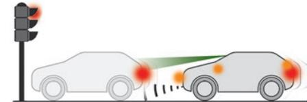
Diese Funktion, die auch als Automatischer Notbremsassistent bezeichnet wird, greift nach der akustischen Warnung ein, wenn der Fahrer das Bremspedal des Fahrzeugs nicht schnell genug betätigt.
