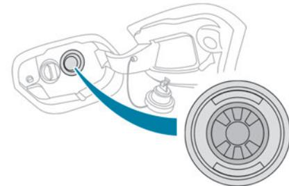
Die Benzin-Zapfpistole stößt beim Einführen in den Tankbehälter Ihres Diesel-Fahrzeugs auf eine Klappe. Das System bleibt gesperrt und verhindert die Befüllung mit Benzin.
