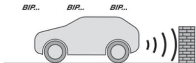
Das System signalisiert das Vorhandensein von Hindernissen sowohl innerhalb des Sensorerkennungsbereichs als auch im Fahrzeugweg, der durch die Ausrichtung des Lenkrads bestimmt wird.
