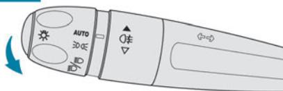
► Ziehen Sie den Lichtschalterhebel zu sich heran, um zwischen Abblend- und Fernlicht umzuschalten. Im Modus „**AUTO**“ und bei eingeschaltetem Standlicht schalten Sie das Fernlicht direkt ein („Lichthupe“), indem Sie am Lichtschalterhebel ziehen.
