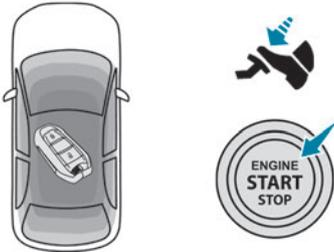
► Stellen Sie bei einem **Schaltgetriebe** den Schalthebel in Leerlaufstellung und treten Sie das Kupplungspedal ganz durch.
