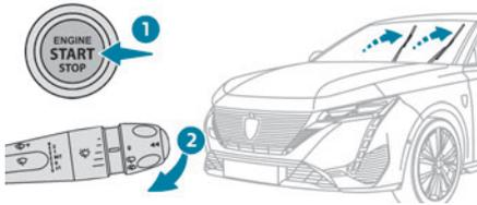
Jede Betätigung des Scheibenwischerhebels unmittelbar nach Ausschalten der Zündung bewirkt, dass die Scheibenwischer senkrecht gestellt werden.
