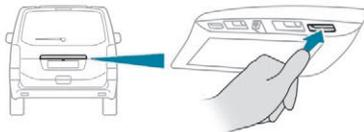
Drücken Sie, das Keyless-System bei sich tragend, auf den Verriegelungsschalter der Heckklappe, um das Fahrzeug zu verriegeln.
