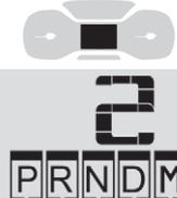
Wenn der Gangwählhebel bewegt oder die Taste **M** gedrückt wird, erscheint das entsprechende Symbol auf dem Kombiinstrument.
