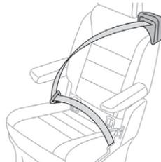
Diese sind mit Dreipunktgurten ausgestattet, die jeweils über eine Führung und einen Gurtaufroller an der Rückenlehne verfügen.
