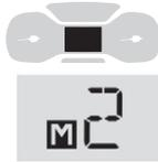
Wenn der Gangwählhebel bewegt wird, erscheinen die Kontrollleuchte und der entsprechende Gang auf dem Kombiinstrument.
